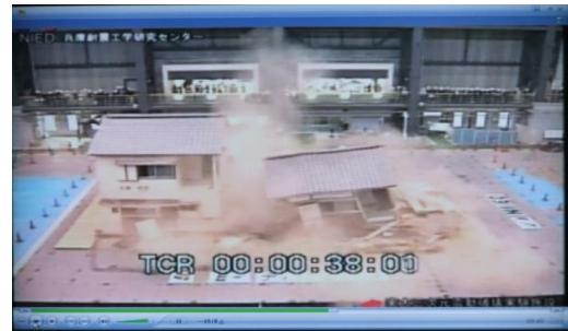
耐震実験映像(昭和56年5月以前の住宅) ・左の木造住宅は耐震改修後(倒壊しない) ・右の木造住宅は耐震改修前(倒壊する)
